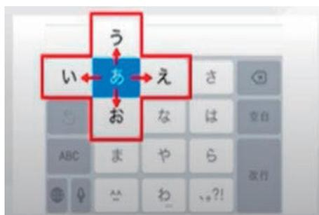
「う」と入力する場合「あ」のキーを長押しします。長押しすると上下左右の4方向に「い・う・え・お」が出るので、「う」であれば上方向にサッと指を払うように画面をなぞれば「う」が入力されます。
