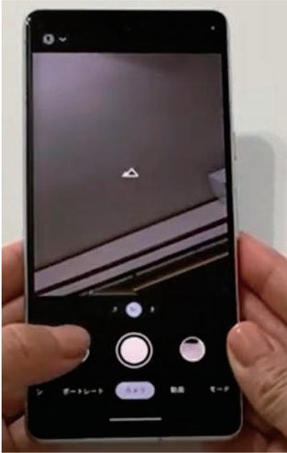
正面のカメラと背面のカメラを切り替えるアイコンをタップする度に、正面、背面のカメラが切り替わります。
