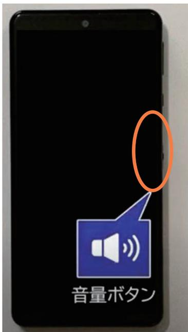
音量ボタン (+)、音量ボタン (-) は、音量の調整をします。
